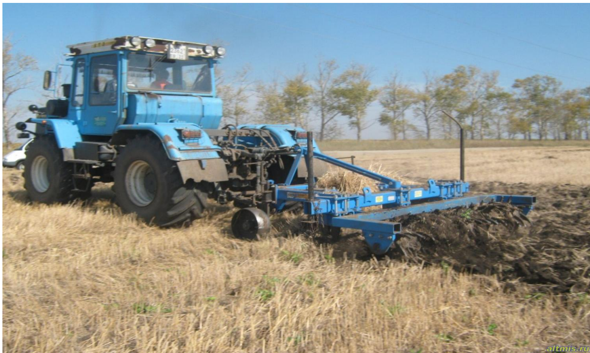
Рис. 3.3. Чизельний обробіток ПЧ-2,5+ПСТ-2,5 на глибину 23-25 см
